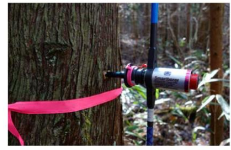
成長錘を用いた木材の採取
