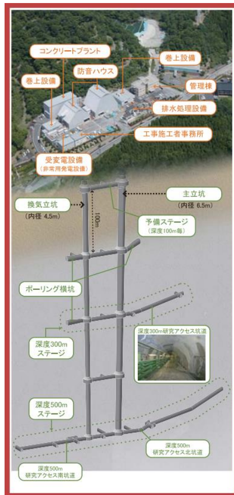
図 2 瑞浪超深地層研究所の施設構造
