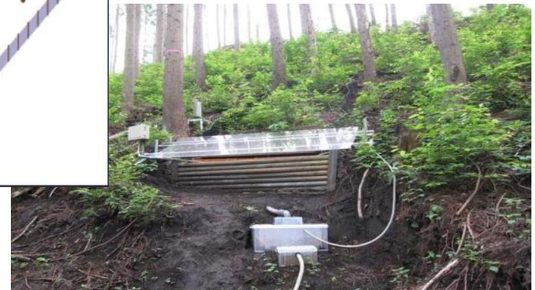
斜面水・土砂流出調査枠
