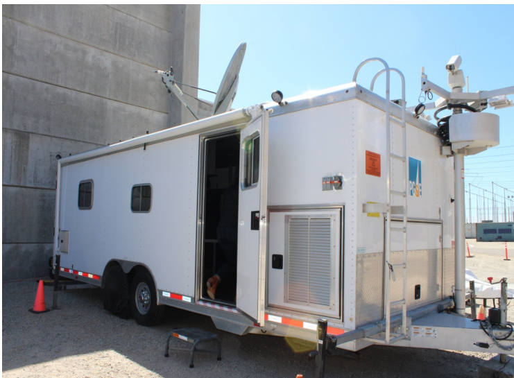
図 9 フクシマの教訓から配備された緊急時通信車
