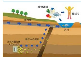
ガラス固化体4万本のオーバーパックすべてが1,000年後にもこの機能を失うとした場合に、地上で生活する人の最大年間被ばく線量は、約0.000005(5×10<sup>-6</sup>)ミリシーベルト(@処分後80万年時点)
