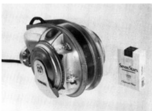
水中 点検ロボット
