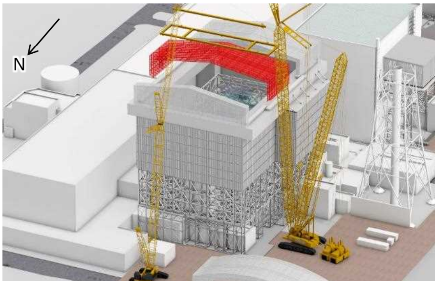
可動屋根設置中
